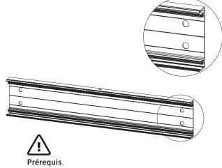
> Pour la dilatation de la lame, prévoir un perçage à Ø 9 mm pour une vis de 5,5 et un perçage à Ø 10 mm pour une vis de 6,3 (prévoir rondelle).
