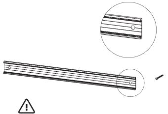
> Pour la dilatation de la lame, prévoir un perçage à Ø 9 mm pour une vis de 5,5 et un perçage à Ø 10 mm pour une vis de 6,3 (prévoir rondelle).
