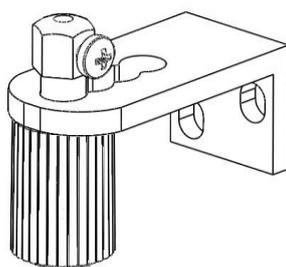
1. Bien trouver le bon endroit de la console de tension, la couverture plastique est nécessaire, avec l'écrou de mécanisme de tension, il faut bien desserrer jusqu'à bout d'un filet de vis de tension (dévisser).
